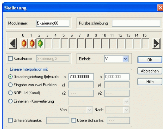
Abbildung 3-6. Lineare Skalierung der drei Eingangskanäle
